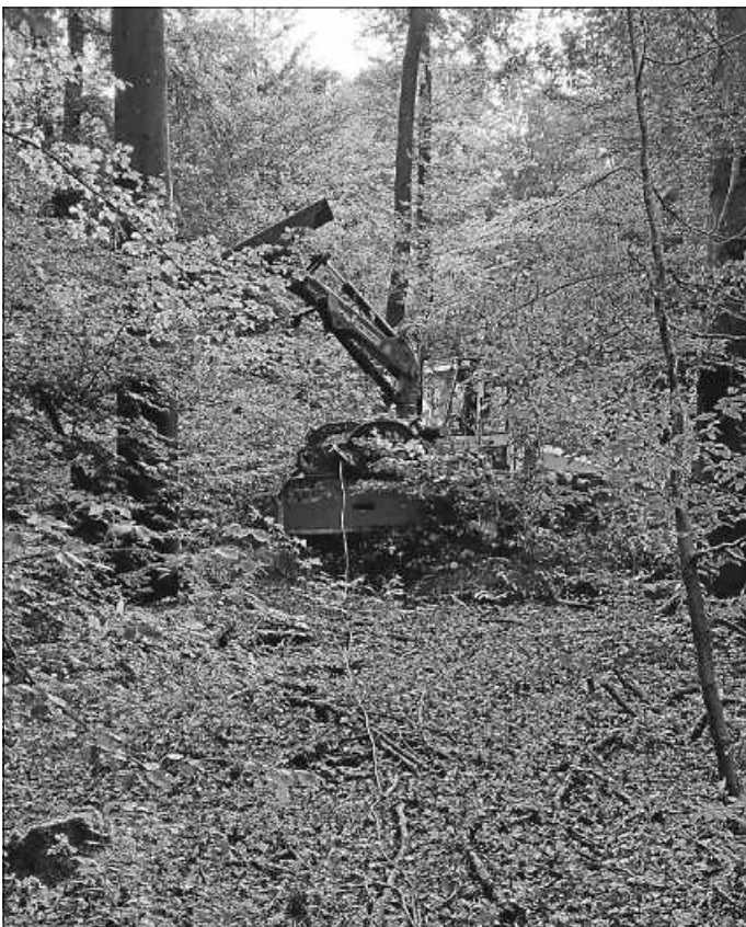
Ohne Maschinen geht bei der Holzernte nichts. Rückefahrzeug mit Kran und Seilwinde Fotos: Michael Philipp Gerster
