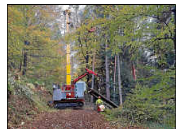
Im Steilhang werden die gefällten Bäume mit einem Seilkran aus dem Hang gezogen.
